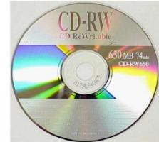
Лазерные дисководы используют оптический принцип чтения информации. На лазерных дисках **CD** (CD — Compact Disk, компакт диск) и **DVD** (DVD — Digital Video Disk, цифровой видеодиск) информация записана на одну спиралевидную дорожку (как на грампластинке), содержащую чередующиеся участки с различной отражающей способностью. Лазерный луч падает на поверхность вращающегося диска, а интенсивность отраженного луча зависит от отражающей способности участка дорожки и приобретает значения 0 или 1.
