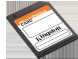
**Flash-память** – это энергонезависимый тип памяти, позволяющий записывать и хранить информацию на микросхемах. Flash-память обеспечивает высокую сохранность данных, высокую скорость записи и считывания информации при небольших размерах. Устройства на основе flash-памяти не имеют в своём составе движущихся частей, что обеспечивает высокую сохранность данных при их использовании в мобильных устройствах.
